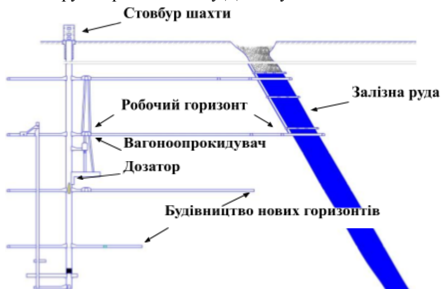
Рис. 1.1. Фронтальна проекція (розріз) основних шахтних виробок
