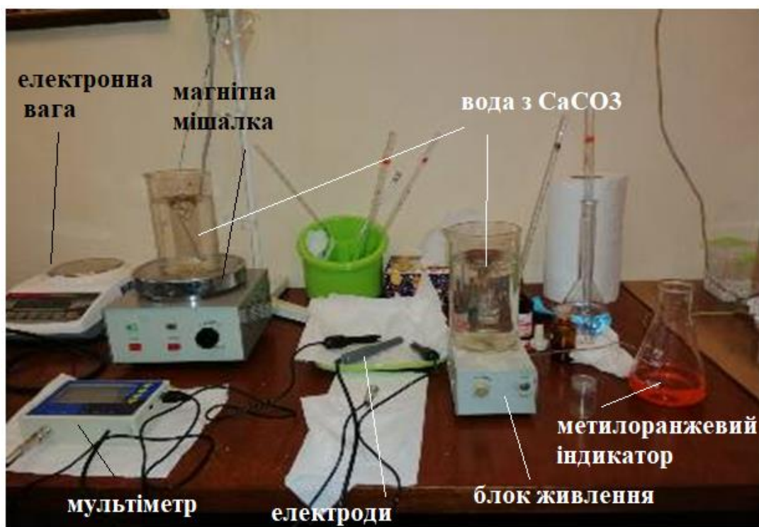
Рис. 2. Обладнання, що використовувалось для лабораторно-експериментальних досліджень з визначення оптимальної дози гранульованого карбонату кальцію для внесення у воду закислених водою
