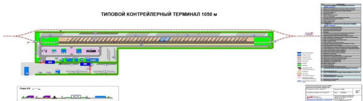
Рис. 3.6. Схема типового контрейлерного терміналу з довжиною вантажного фронту 1050 м – Варіант 1
