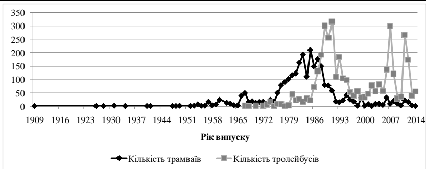
Рис. 2.13. Рік випуску трамваїв та тролейбусів, що експлуатуються в Україні, станом на 01.01.2015 р. Побудовано за: [72]
